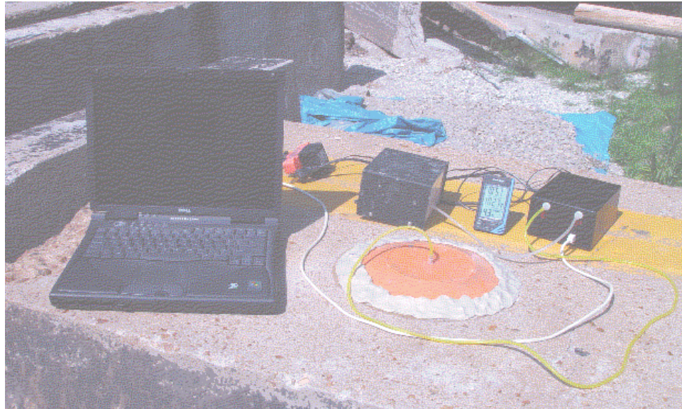
Figure 19: Kuss Permeability Setup
